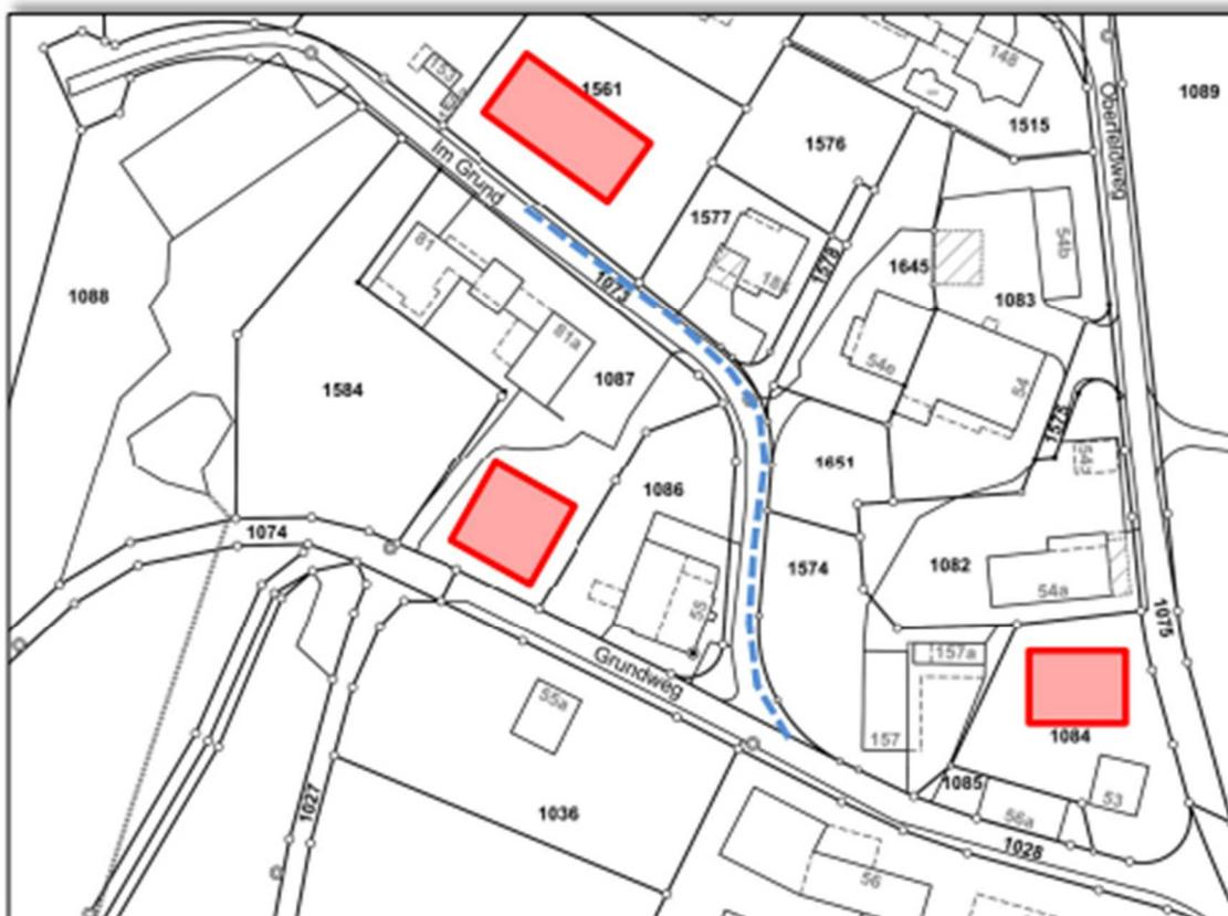
Darüber hinaus ist am Grundweg eine Mutation der Parzelle 1087 vorgesehen. Die bestehende Mischwasserkanalisation (DN300) durchquert die neu entstehende Parzelle 1694 und muss zur Umsetzung eines privaten Bauvorhabens umverlegt werden. Bestehend ist das Mindestgefälle für Mischwasserkanalisation mit knapp 1.6% unterschritten. Allerdings sind keine hydraulischen Problematiken bekannt. Die bestehende Mischwasserkanalisation wird ab und entlang der Grenze zu Parzelle 1086 umverlegt.
